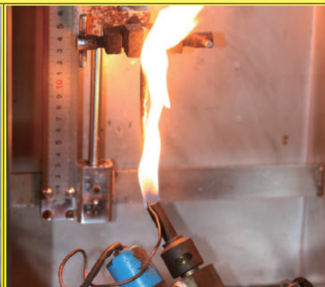
正在进行UL94VO检测的样条
