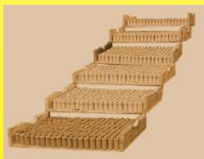
手工锤子压制后高频瓷绝缘子的干化（私人收藏）
